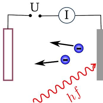
Heinrich Hertz stellte im Jahr 1886 fest, dass Elektronen unter dem Einfluss von UV-Strahlung aus einer Metalloberfläche austreten können. Im Jahr 1905 lieferte Albert Einstein die korrekte Erklärung für diesen sogenannten *photoelektrischen Effekt*, was ihm 1921 den Nobelpreis für Physik einbrachte:
