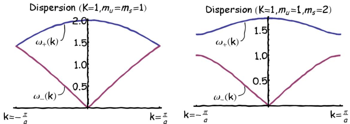
Abbildung 2: **Links** Entarteter Fall: optische und akkustische Moden über  $k$  aufgetragen. **Rechts** Entartung aufgelöst: Optische und akkustische Moden als separierte Energiebänder über  $k$  aufgetragen.
