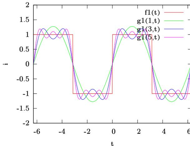
Abbildung 1: Plot von  $f_1(t)$  (im Imaginären). Wir plotten die Reihe mit  $N = 1, 3, 5$ , da jeweils die geraden Terme verschwinden. Daher erhalten wir für  $N = 1$  und  $N = 2$  den selben Plot.
